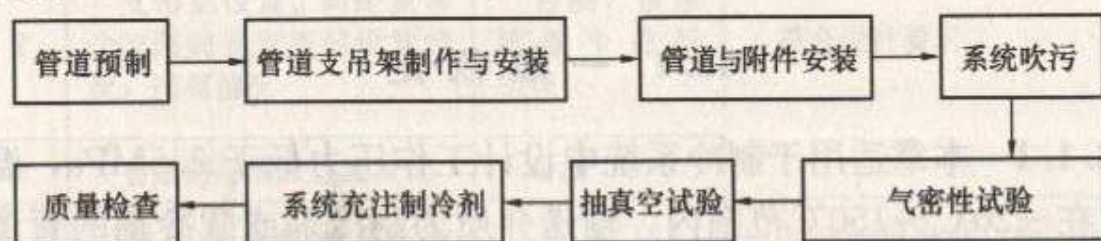
图 12.2.1 空调制冷剂管道与附件安装工序
